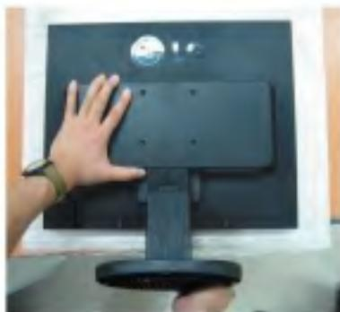
4. Sujete el producto del otro modo que se indica y gire la base del soporte en la dirección de la flecha.
